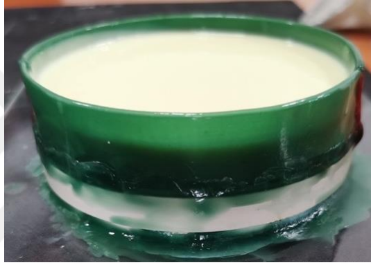
Şekil 3-6: Endüstriyel silikon ile kalıpların hazırlanışı
