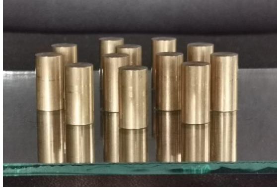
Şekil 3-5: Pirinç silindirlerin cam üzerine sabitlenmesi
