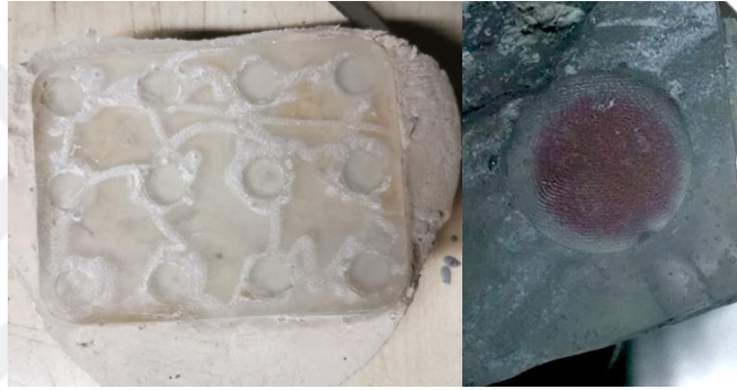
Şekil 4-1: PEKKBond ile bağlantı sağlanamamış örnekler
