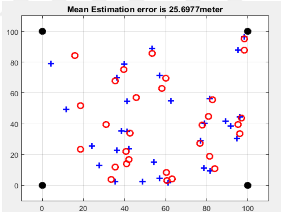
Şekil 4.6: GOA 30 yeri bilinmeyen sensörle yapılan lokalizasyon işlemi
