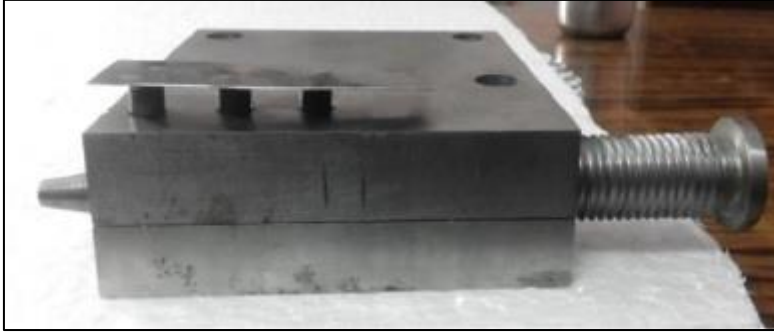
Resim 7.2. Konik mil yükseklik ayarı aparatı (Lata ve Hitesh, 2020)
