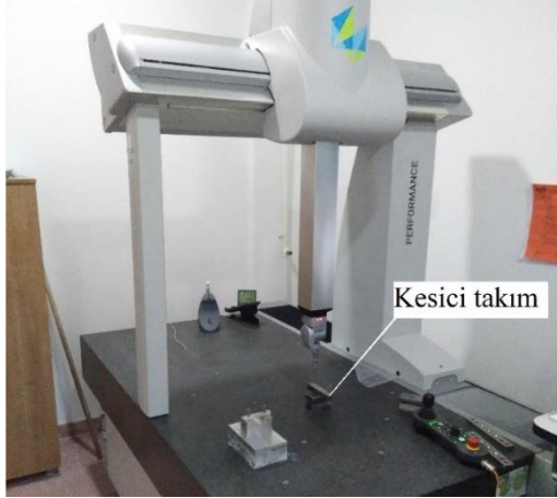
Resim 8.9. CMM tezgahında kesici takım fonksiyonel yükseklik ölçümü
