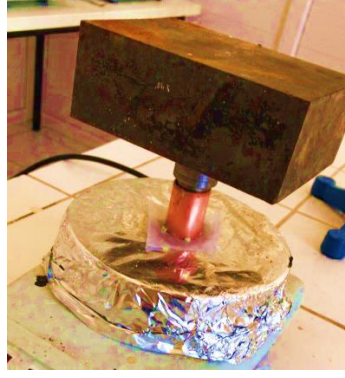
Şekil 4.14. Efervesan tabletin oluşturulmasında kullanılan kalıp düzeneği
