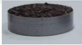
Şekil 11. Karıştırılmalı değirmen modeli için kullanılan sıkıştırılmış yatağın fotoğrafı
