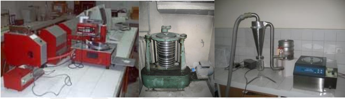
Şekil 7. Soldan sağa Lazerli tane boyu ölçüm cihazı, rotap elek sallayıcı, havalı alpine elek
