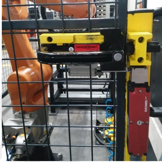
Şekil 4.12. Euchner Marka (BTC-ST/G-S-TH-01-F Model) Kapı Kilidi
