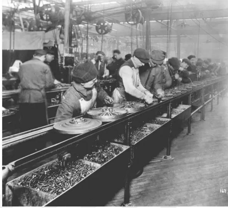
Şekil 2.5. Bir Otomobil Fabrikasında Yürüyen Bant ve Seri İmalat Örneği (Web4,2021)
