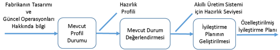
Şekil 4.1. Akıllı Üretim Sistemi İçin Hazırlık Seviyesi Değerlendirme Yapısı
