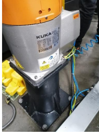
Şekil 4.13. Robot Zemin Bağlantısı
