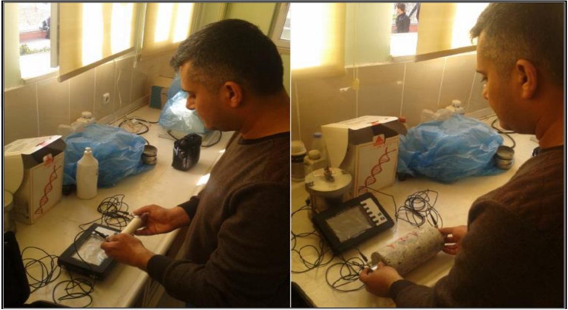
Şekil 4.13. Ultrases cihazına kalibrasyon yapılması ve numunelere uygulanan ultrases deneyi
