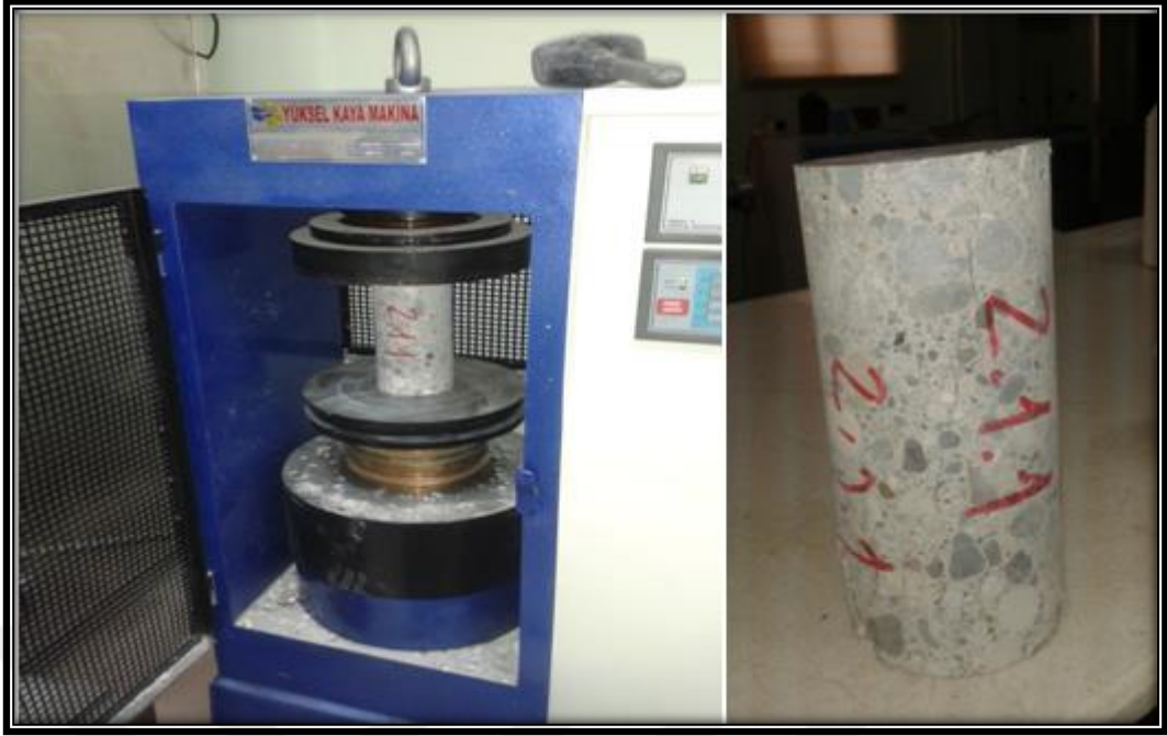
Şekil 4.14. Karot numunelerine uygulanan basınç deneyi
