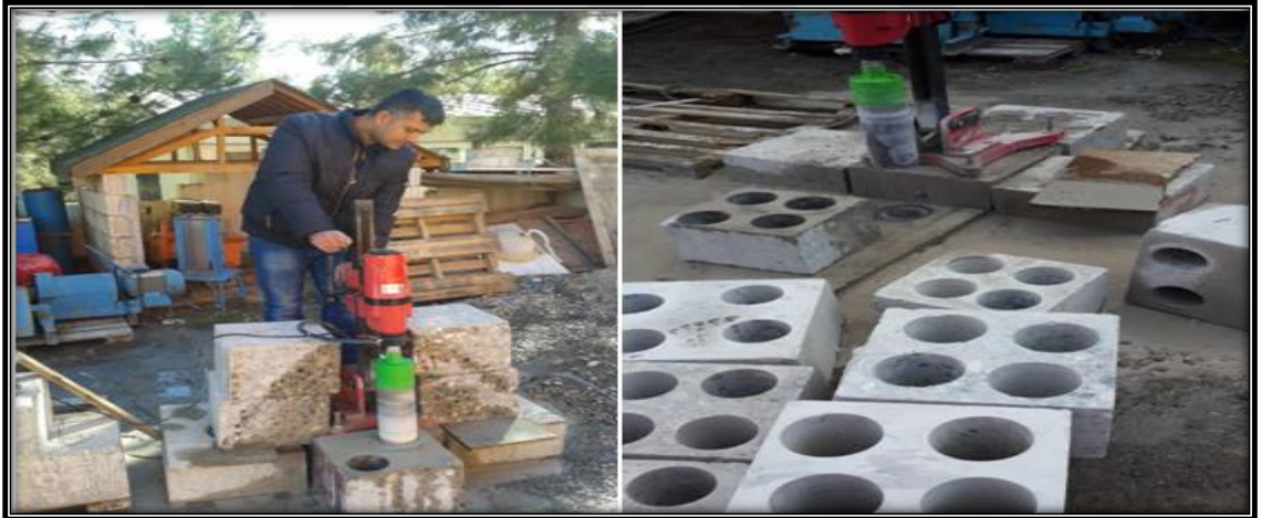
Şekil 4.8. Karot alma işlemi
