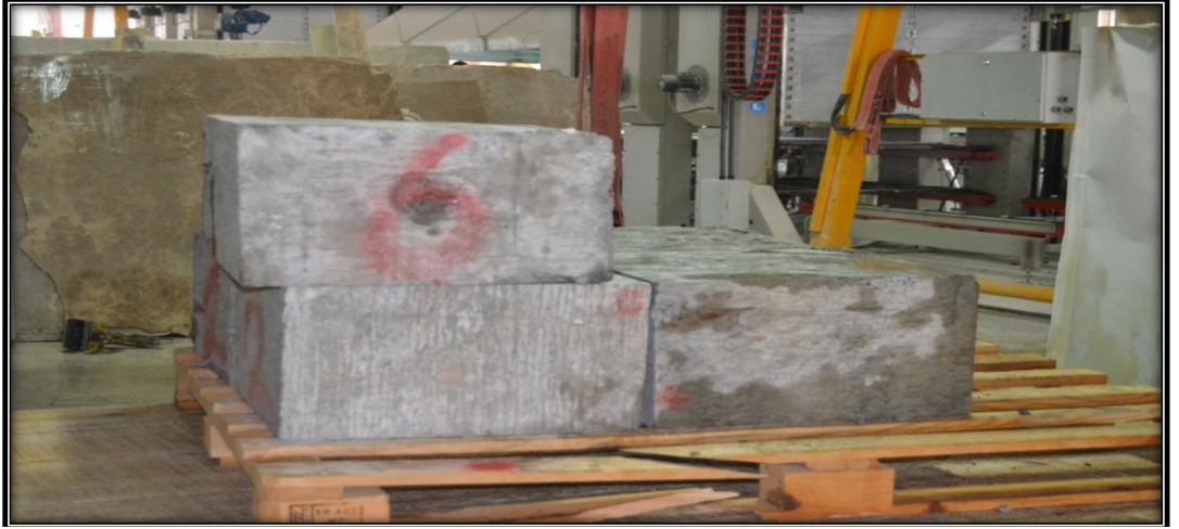
Şekil 4.7. 40x40x25 cm boyutlarına kesilen beton numuneleri
