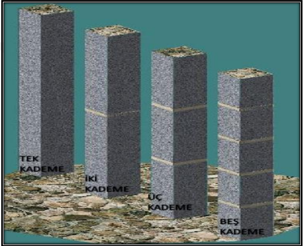
Şekil 4.2. Kolonlara uygulanan beton döküm planı
