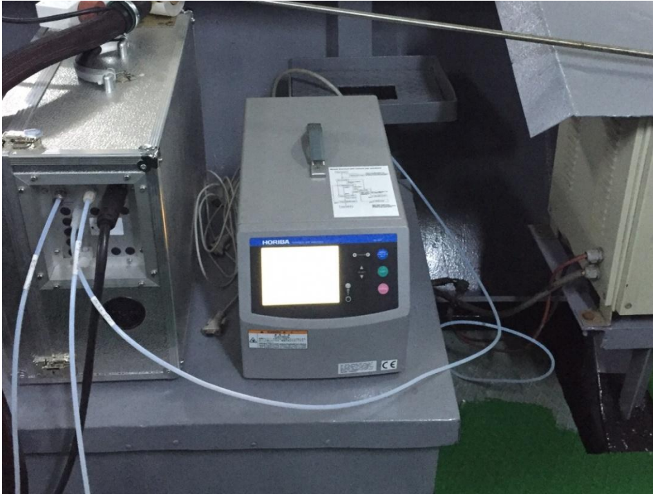
Şekil 3.1 : Horiba PG 250 gaz analizörü.
