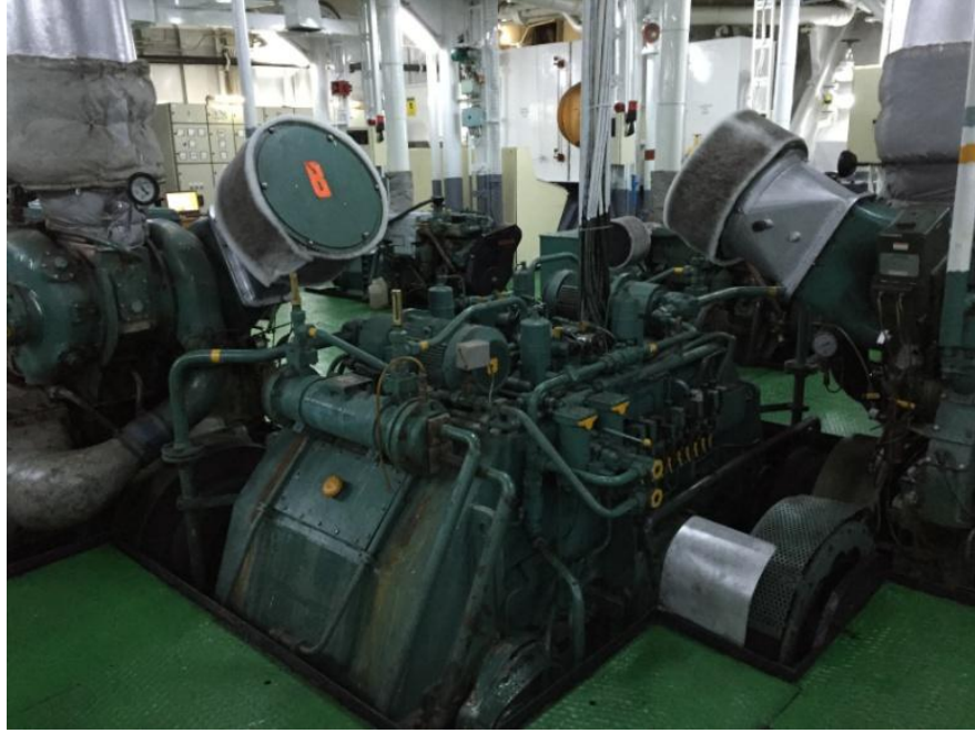
Şekil 5.2 : Ana makine ve şanzıman yerleşimi.
