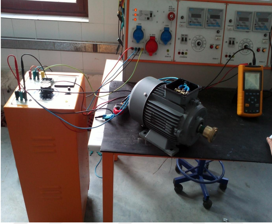
Şekil 6.2. Boşta çalışma deney düzeneği.
