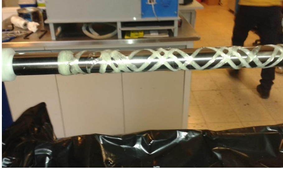
Şekil 4.5 Filamentin mandrel üzerine istenen açıda sarımı
