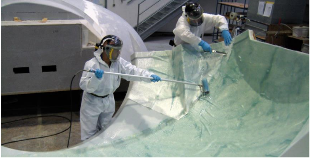
Şekil 3.1 Elle yatırma işlemi uygulaması
