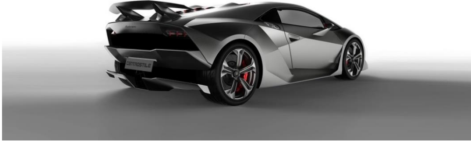
Şekil 2.7 Karbon fiber kaportalı otomobil (999 kg) [32]
