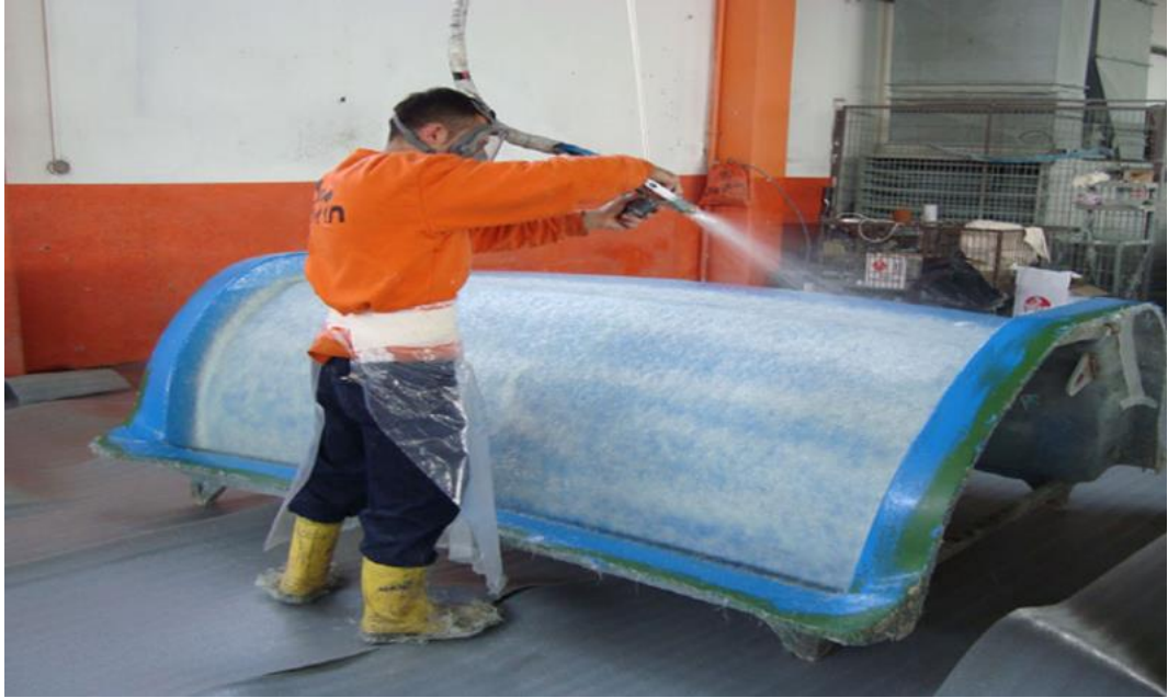
Şekil 3.2 Püskürtme işlemi uygulaması
