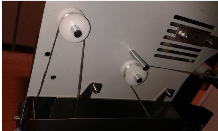
Şekil 4.4 Filamentin reçine havuzundan geçecek şekilde ayarlanması
