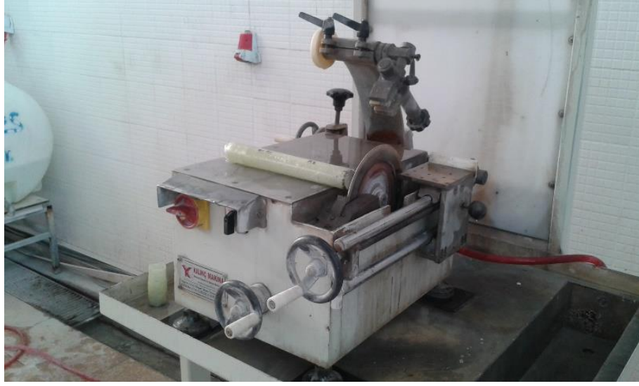
Şekil 4.8 Test için gerekli ölçüde numune kesimi
