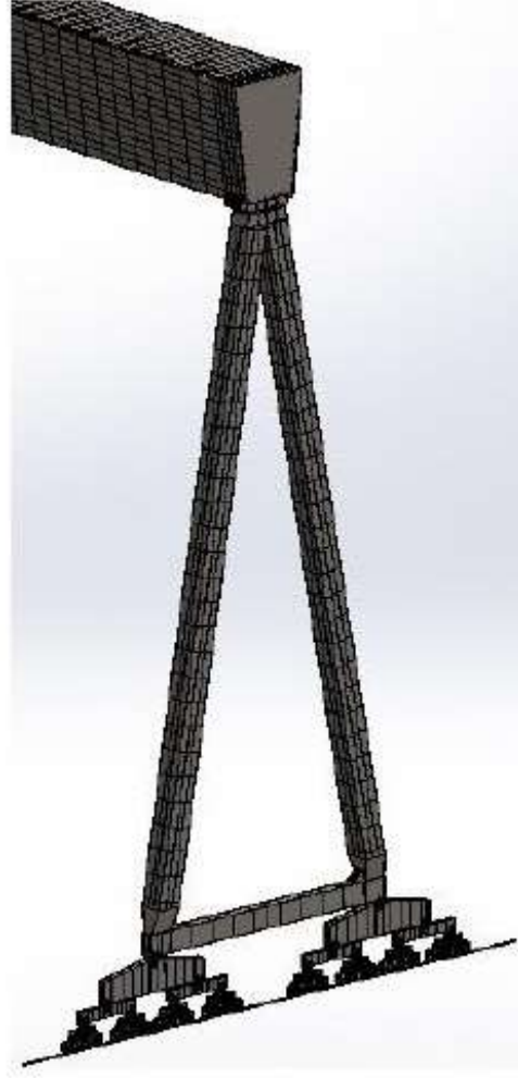
Şekil 5.6: Mafsal bacağa ait üç boyutlu model.
