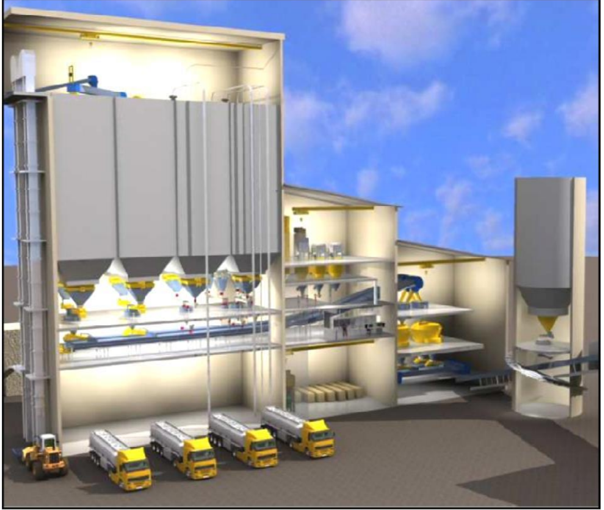
Şekil 2.6: Harman Binası İş Akımı
