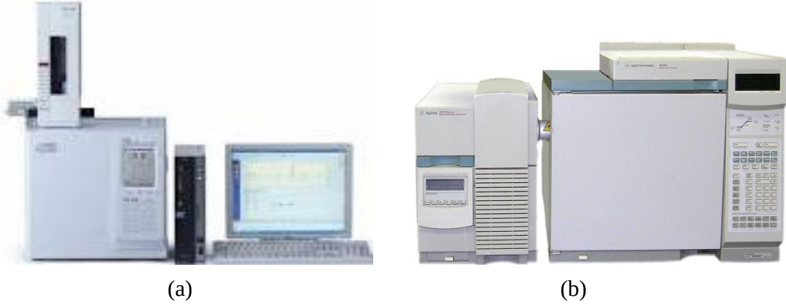
Şekil 5.8. GC analizlerinin yapıldığı cihazlar (a. Shimadzu GC 2025 b. Agilent 6890N/Agilent 5973 GC-MS)
