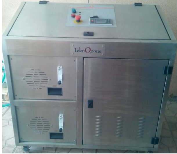
Şekil 5.2. Yağların ozonlanmasında kullanılan ozon jeneratörü
