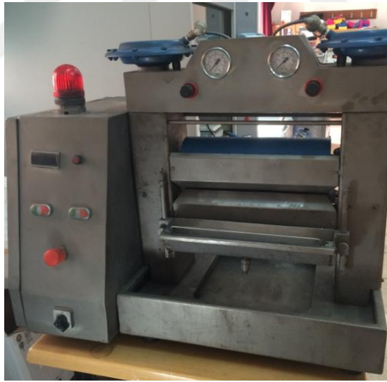
Şekil 5.4. Emdirme aplikasyonlarının yapıldığı laboratuvar tipi fulard
