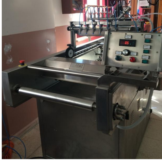
Şekil 5.5. Püskürtme aplikasyonlarının yapıldığı laboratuvar tipi püskürtme makinesi
