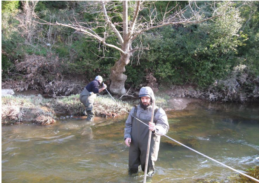
Şekil 4.1 : Arazi çalışmaları sırasında yapılan enkesit ölçümleri.
