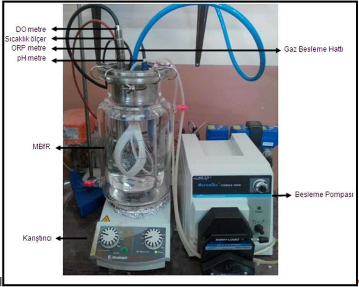
Şekil 3.4. Tasarlanan membran biyofilm reaktör
