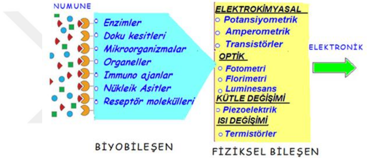
Şekil 1.2. Biyosensörlerin yapısı ve çalışma prensibi
