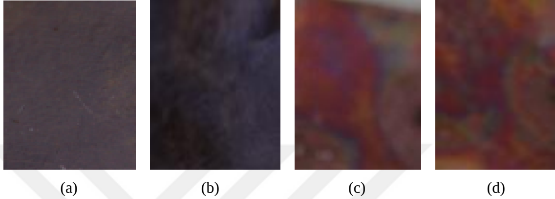
Şekil 4.19. Pt/POT (a) , Pt/POT/HCl (b), Pt/POT/HCl/Chi+GOD (c), Pt/POT/HCl/Chi+GOD/GAL (d) elektrotların dijital fotoğrafları
