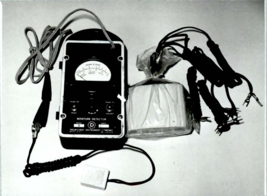
Resim: 2- Rutubet ölçme aleti ve alçı bloklar
