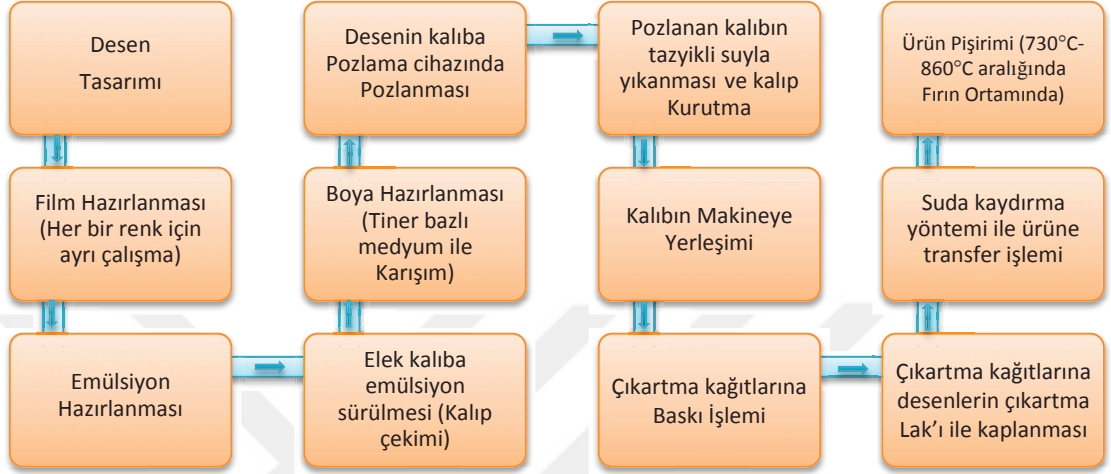
Resim 2.1.2.3. Dolaylı baskı (çıkartma) tekniği uygulama aşamaları
