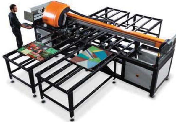
Resim 3.1.1.6. Dip Tech Gp Serisi modeli dijital baskı makinesi
