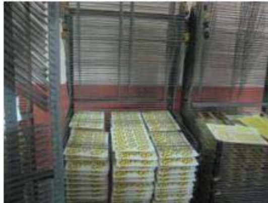
Resim 2.1.2.2. Çıkartma kağıtlarının kurutma rafına yerleştirilmesi
