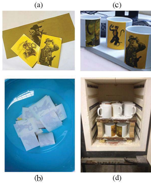
Resim 5.2. (a) Baskının kurumasının ardından lak atılmış çıkartma kağıdı (b) Çıkartma kağıdının transfer aşaması için suda beklemesi (c) Çıkartma lastiği
