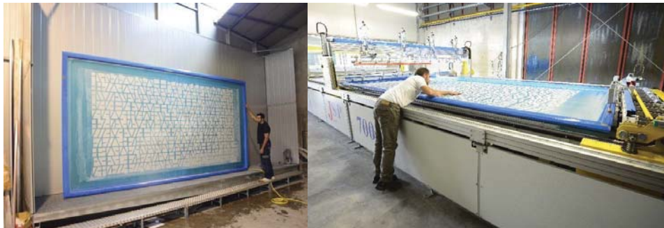
Resim 2.1.1.2. Cam üzerine doğrudan baskı (elek baskı) kalıbın otomatik baskı makinesine yerleştirilmesi
