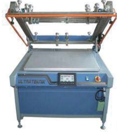
Resim 2.1.11. Yarı Otomatik Serigraf (dolaylı- çıkartma) Baskı Makinesi
