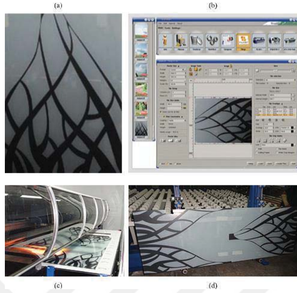
Resim 2.2.2. (a) Tasarım (b) Görsel düzenleme yazılımıyla tasarımı baskıya hazırlama. (c) Baskı İşlemi ve U.V Kurutma (d) Baskının son hali
