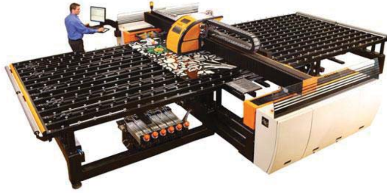
Resim 3.1.1.5. Dip Tech Glass Jet PRO modeli dijital baskı makinesi
