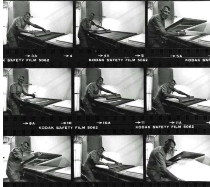
Resim 2.1.2.6. Crittington Maccoy çıkartma kağıdına serigrafî uygulama
