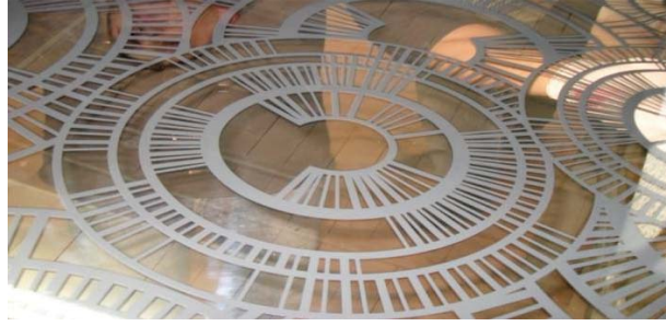
Resim 2.1.1.3. Cam üzerine elek baskı uygulaması
