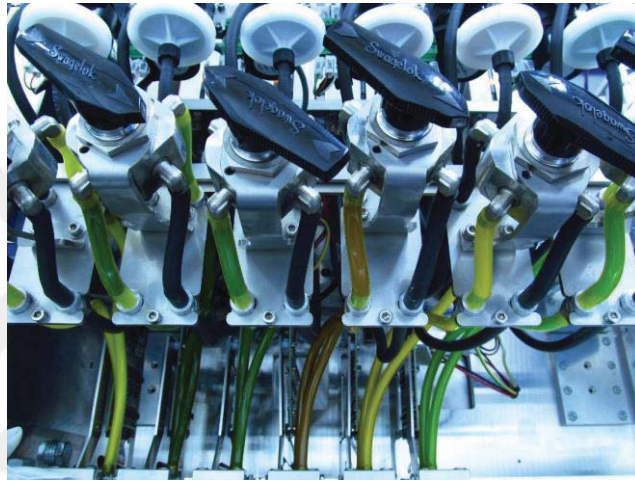
Resim 3.1.2.7. Tecglass baskı kafası Inverflow tıpları
