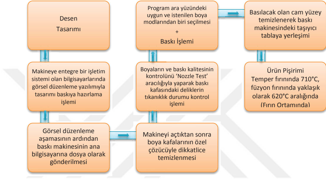
Resim 2.2.1. Dijital baskı tekniği uygulama aşamaları
