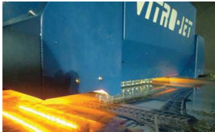
Resim 3.1.2.2. Tecglass Vitro-jet baskı yapımında eş zamanlı UV kurutma
