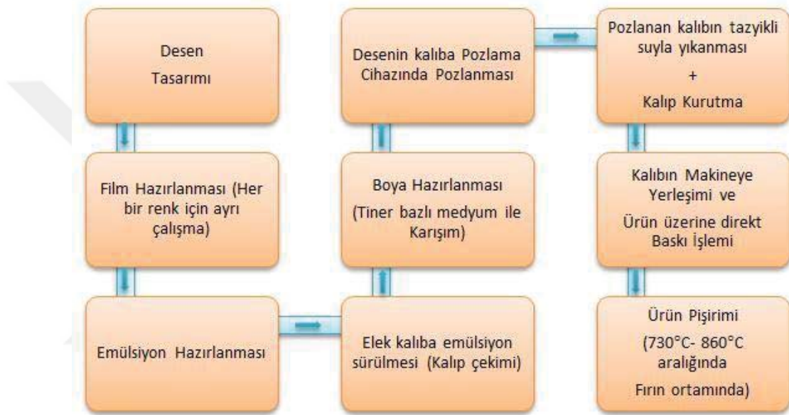
Resim 2.1.1.1. Doğrudan baskı (elek baskı) tekniği uygulama aşamaları
