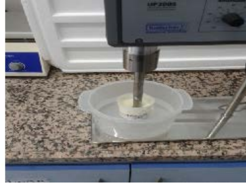
Şekil 3.3. Katma (spiking) uygulanmış örneklere ultrasound uygulaması
