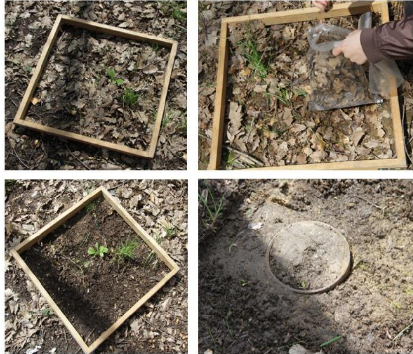
Şekil 3.18: Doğal yapısı bozulmuş (torba) ve doğal yapısı bozulmamış (silindir) toprak örneklerinin alınması.
