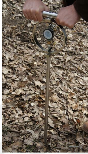
Şekil 3.19: Penetrometre ile toprak kompaktlaşmasının ölçülmesi.
