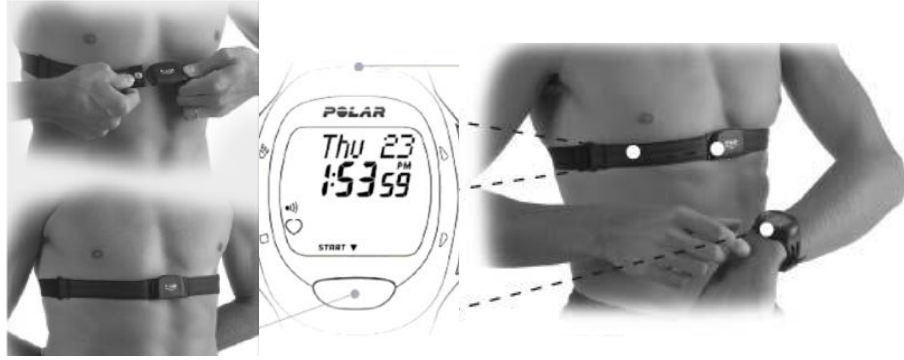
Şekil 3.1. Kalp atış hızını ölçen monitör (Polar s625x); göğüs bandı, birleştirici ve nabız saati.
