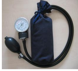
Resim 2: Adapte edilmiş sfigmomanometre (Uğurlu Ü, Özdoğan H. Development of normative data for cylindrical grasp pressure. Int J Ind Ergon. 2011)
