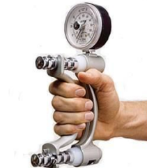
Resim 17: Jamar El dinamometresi ile kavrama kuvveti ölçümü.
