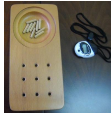
Resim 19: El becerilerinin ölçülmesinde kullanılan Dokuz Delikli Çivi Testi.
