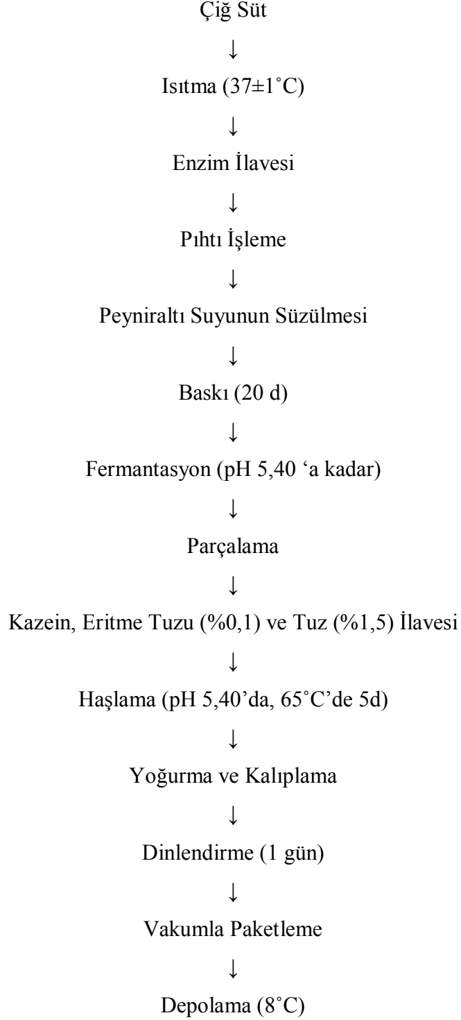
Şekil 2.1. Kaşar peyniri üretim akış şeması
