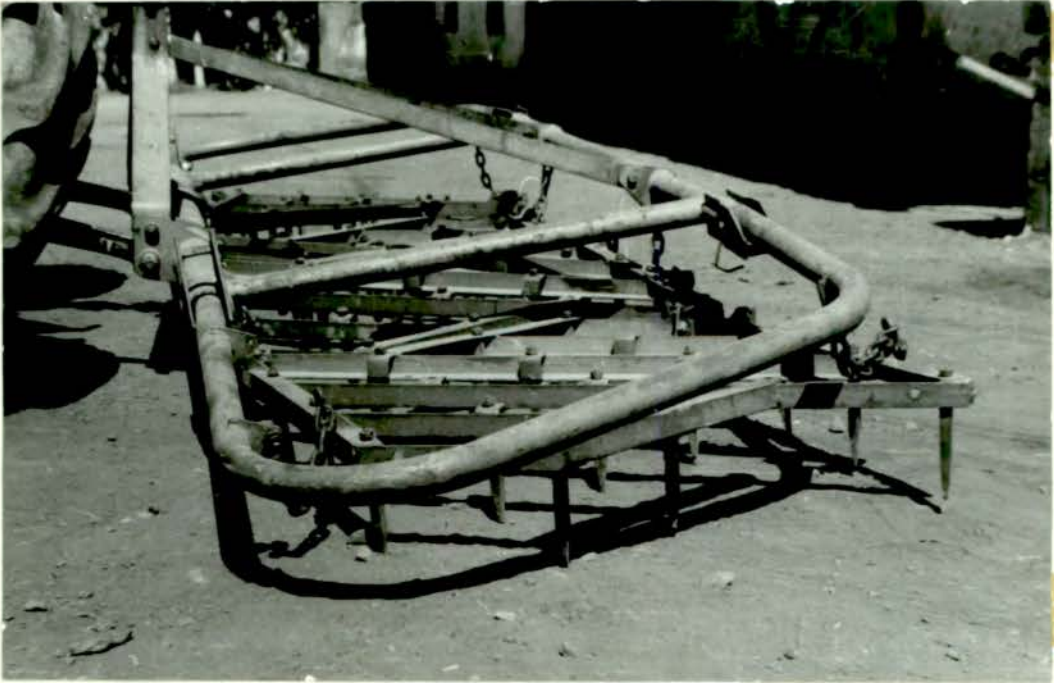
Resim: 1- Sonbaharda gübre tatbikinden önce ve sonra, gübrelerin toprakla karışmasına ve toprağın havalanmasını sağlamak gayesiyle çayır ve mer'a alanlarına tatbik edilen pancar tırmağı.
