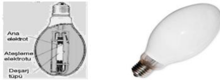
Şekil 2.11. Yüksek basınçlı cıva buharlı lambalar ve yapısı.
