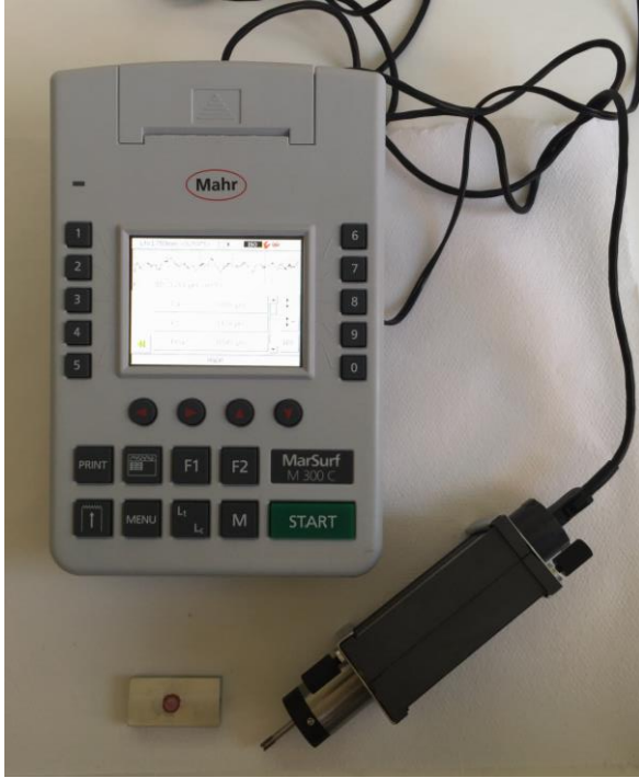
Resim 3.10. Mobil pürüzlülük cihazı ile örneklerin yüzey pürüzlülüğünün ölçülmesi
