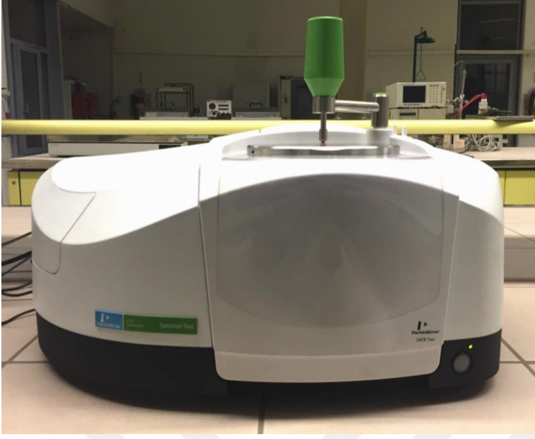
Resim 3.11. FTIR analizi uygulaması
