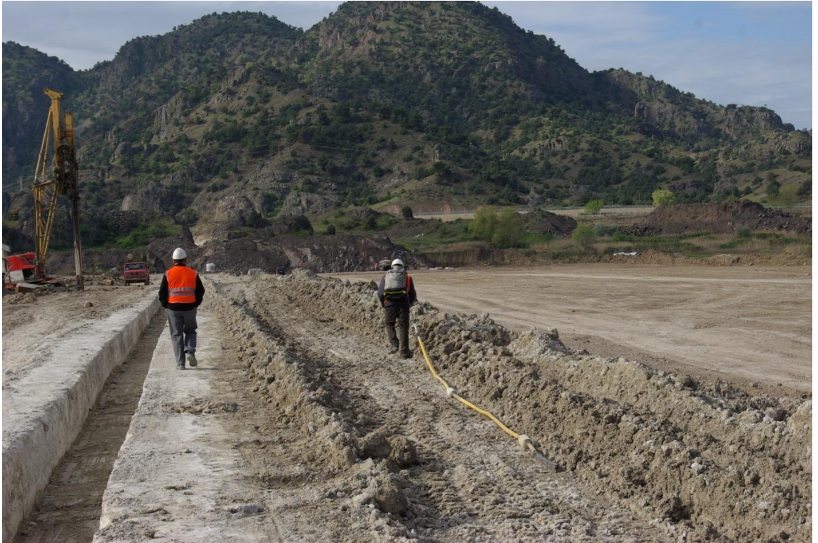
Şekil 3.3. Çalışma alanında 50 MHz RTA GPR anteni ile ölçüm alma işlemi
