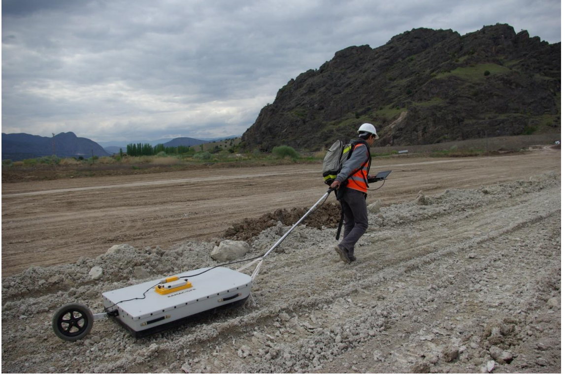
Şekil 3.2. Çalışma alanında 100 MHz korumalı GPR anteni ile ölçüm alma işlemi
