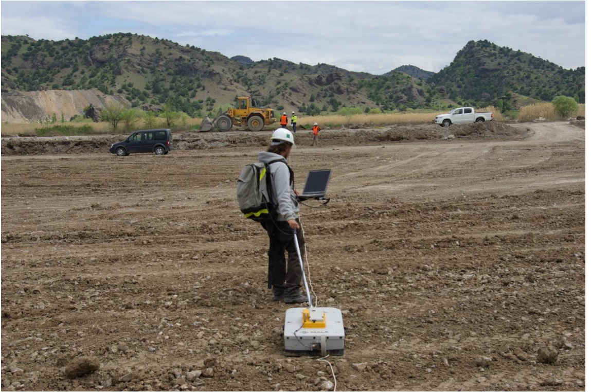
Şekil 3.1. Çalışma alanında 250 MHz korumalı GPR anteni ile ölçüm alma işlemi
