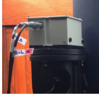
Şekil 3.11 : Hafifletilmiş adaptörün eğimölçer ile birlikte görünümü.
