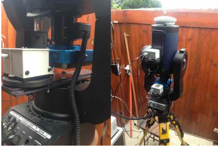
Şekil 3.12 : Alt yapıya ve tüpe yerleştirilen iki eğimölçer.
