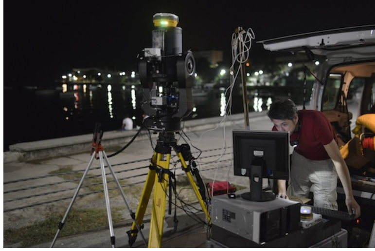
Şekil A.14 : Kadıköy istasyonunda Jeodezik koordinatların ölçülmesi.
