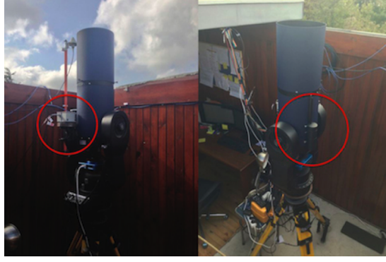
Şekil 3.10 : Sistem üzerindeki eğimölçer, adaptör ve ağırlıklar.
