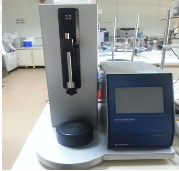
Şekil 3.2 Nanolifli yüzeylerin daldırarak kaplama yönteminin yapıldığı cihaz
