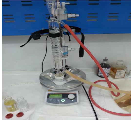
Şekil 3.6 GdO-NP sentezi geri akımlı inkübasyon düzeneği.
