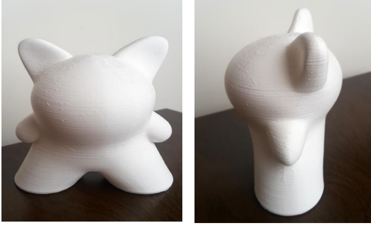
Resim 3.47. Blue Panther tasarım oyuncuğunun 3 boyutlu baskı makinesinden çıkan form, boyut: 10x11x8 cm, malzeme: PLA plastik, 2016
