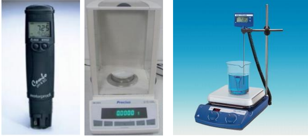
Şekil 3.15. Çeşitli deney ekipmanları: pH metre, hassas terazi ve manyetik karıştırıcı
