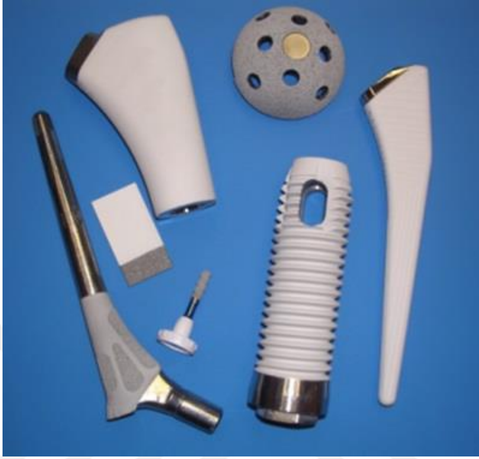
Şekil 3.6. Hidroksiapatit kaplanmış çeşitli implantlar
