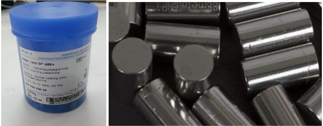
Şekil 3.16. CoCrMo metalik implant malzemeler
