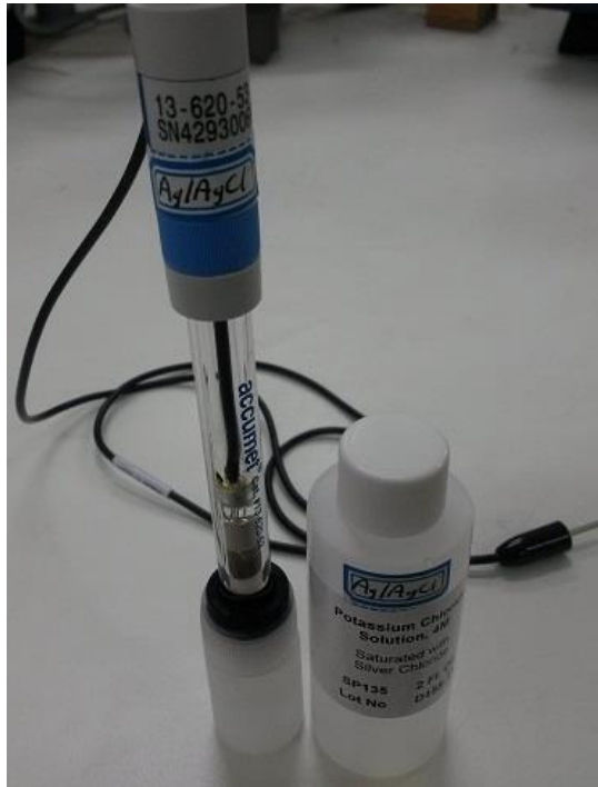
Şekil 3.19. Deneylerde kullanılan referans elektrot
