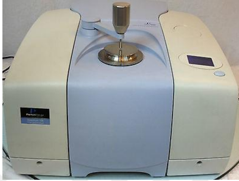
Şekil 3.31. Analizlerde kullanılan PerkinElmer Spectrum One FTIR cihazı
