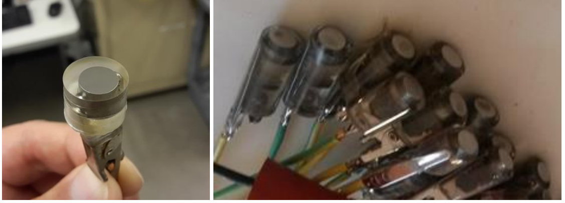
Şekil 3.17. Epoksi ile kaplanarak çalışma elektrodu haline getirilen CoCrMo biyomalzemeler
