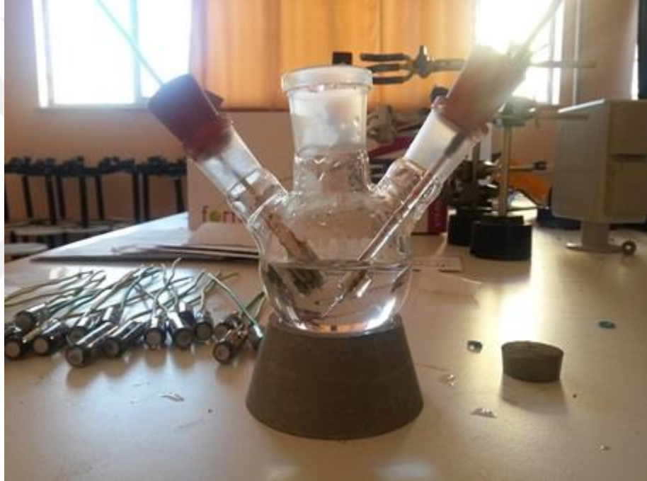
Şekil 3.20. Elektrodpozlamada kullanılan hücre
