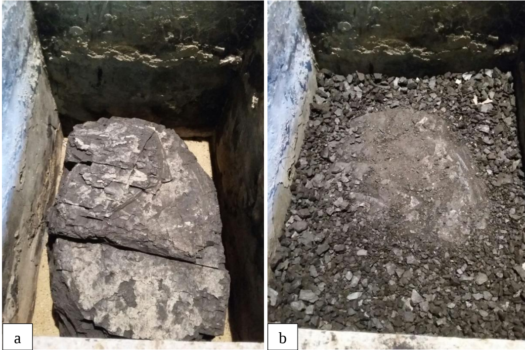
Şekil 4.10: a) Deneyde kullanılan kömür bloğu. b) Kömür ile doldurulan reaktör.
