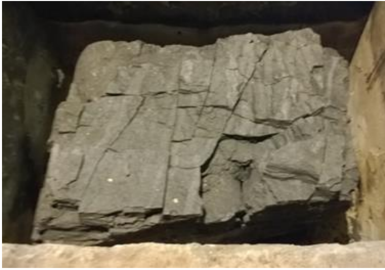
Şekil 4.1: Deneyde kullanılan kömür bloğunun reaktör içerisinde görünümü.
