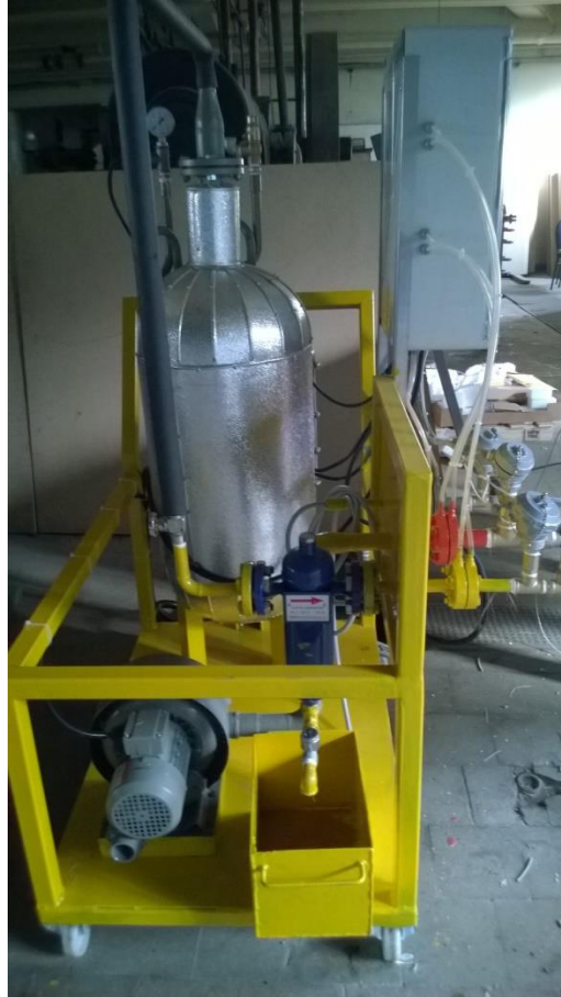
Şekil 3.2: Üfleç, buharlaştırıcı ve oksijen ile azot tüplerinin bulunduğu besleme düzeneği.
