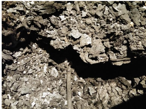
Şekil 4.9: Deney sonucu oluşan oyukun görüntüsü.
