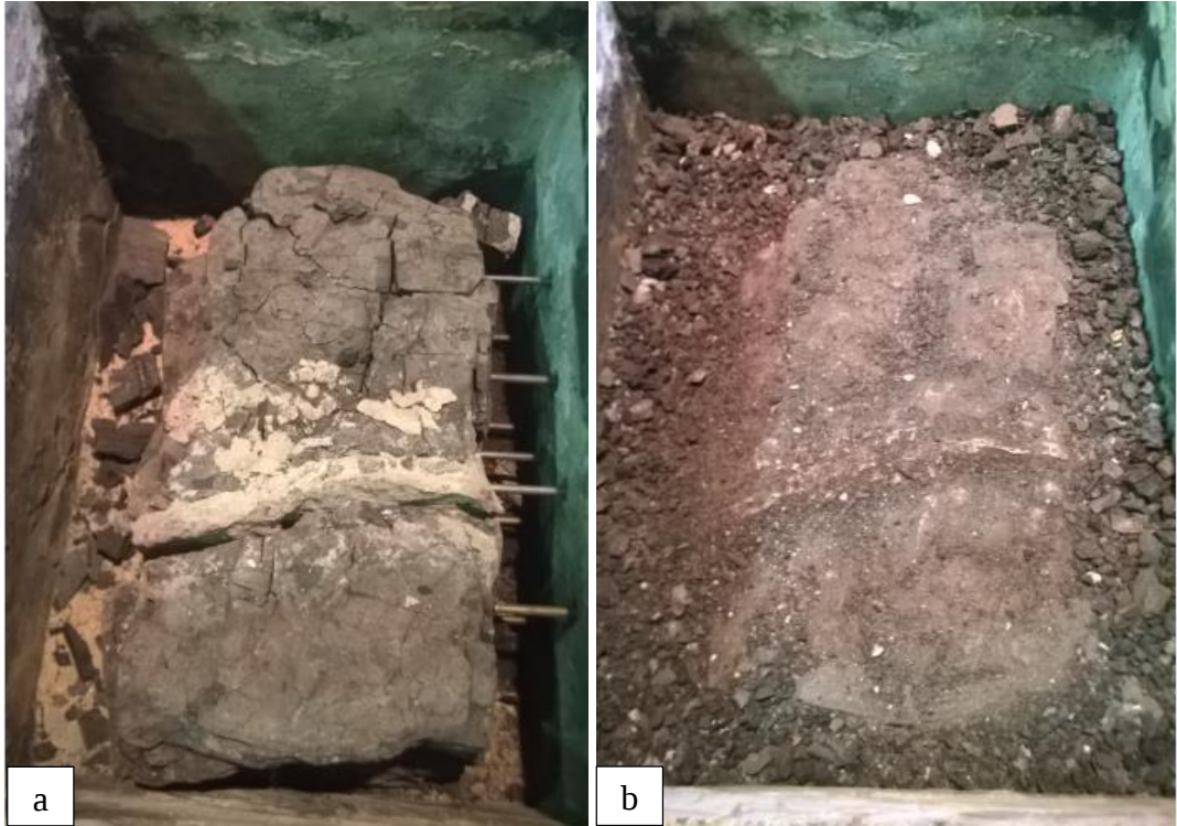
Şekil 4.16: a) Deneyde kullanılan kömür bloğu. b) Reaktörün kömür ile doldurulması.
