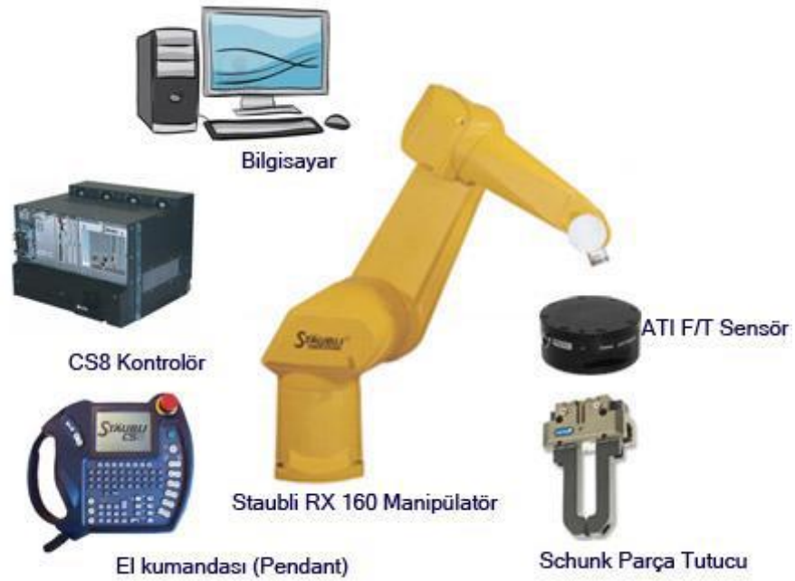
Şekil 1.4: RX-160 Manipülâtörünün donanımı [2].
