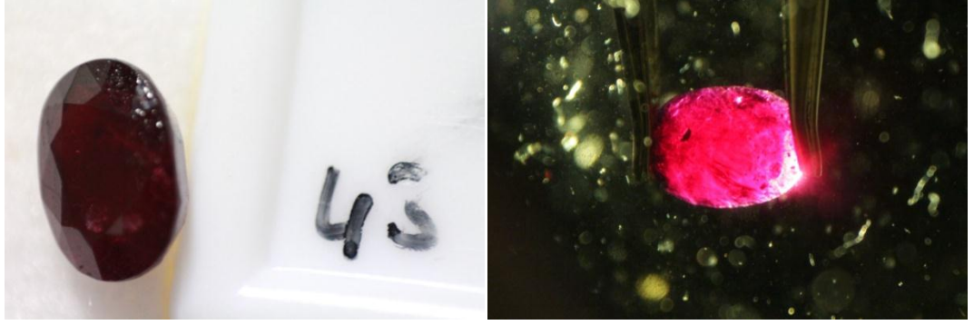
Şekil 3.14 43 nolu yakut taşı örneğinin doğal ortamda ve 1,57 kırılma indisine sahip sıvı içindeki görüntüsü.
