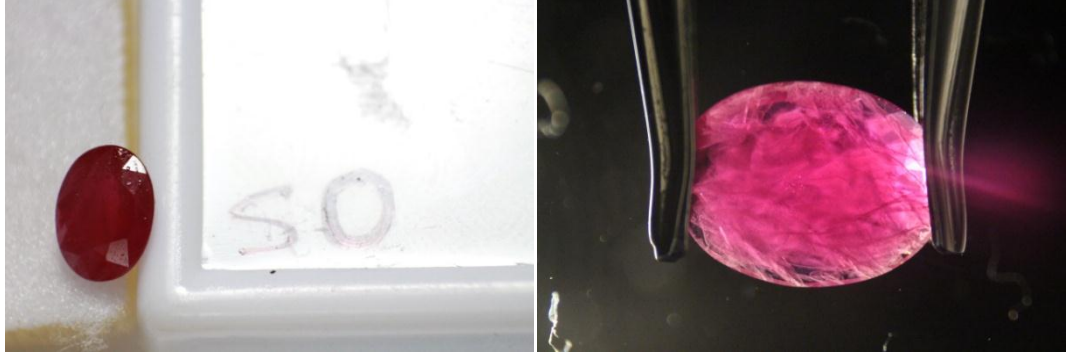
Şekil 3.22 50 nolu yakut taşı örneğinin doğal ortamda ve 1,57 kırılma indisine sahip sıvı içindeki görüntüsü.
