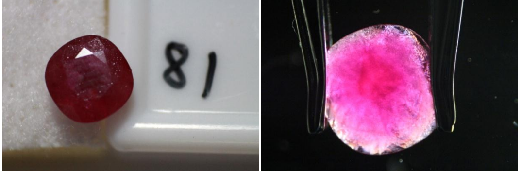
Şekil 3.28 81 nolu yakut taşı örneğinin doğal ortamda ve 1,57 kırılma indisine sahip sıvı içindeki görüntüsü.
