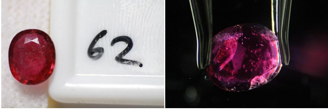
Şekil 3.40 62 nolu yakut taşı örneğinin doğal ortamda ve 1,57 kırılma indisine sahip sıvı içindeki görüntüsü.
