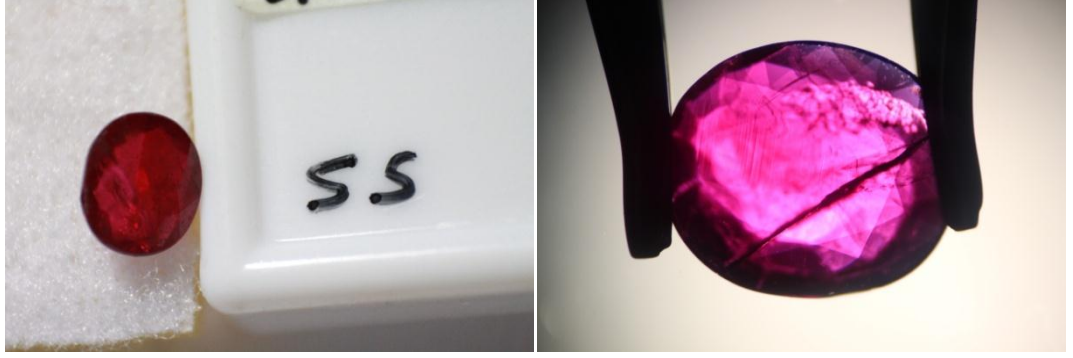
Şekil 3.12 55 nolu yakut taşı örneğinin doğal ortamda ve 1,57 kırılma indisine sahip sıvı içindeki görüntüsü.
