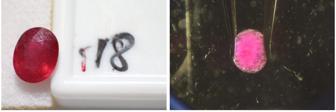
Şekil 3.6 18 nolu yakut taşı örneğinin doğal ortamda ve 1,57 kırılma indisine sahip sıvı içindeki görüntüsü.
