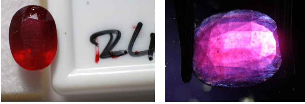
Şekil 3.18 24 nolu yakut taşı örneğinin doğal ortamda ve 1,57 kırılma indisine sahip sıvı içindeki görüntüsü.
