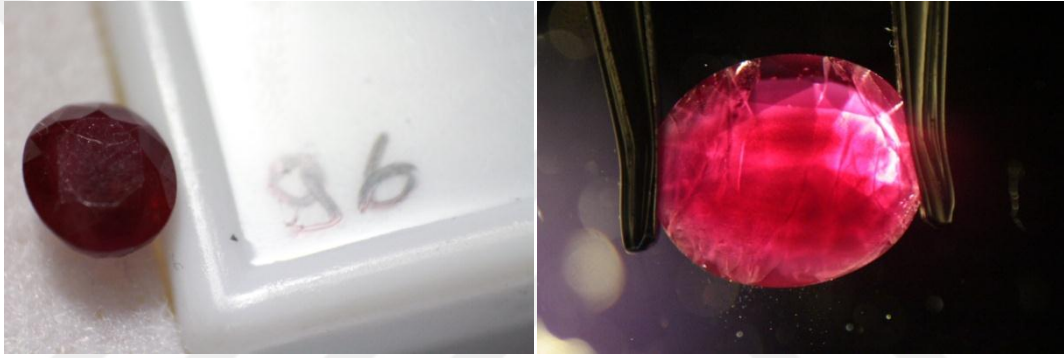
Şekil 3.2 96 nolu yakut taşı örneğinin doğal ortamda ve 1,57 kırılma indisine sahip sıvı içindeki görüntüsü.
