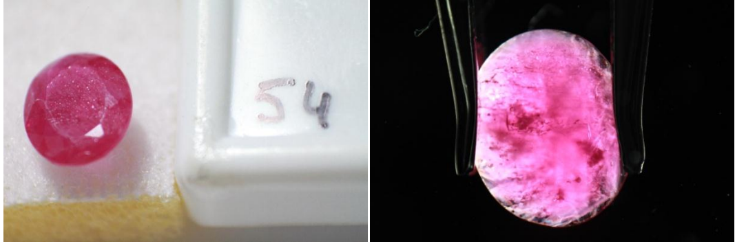
Şekil 3.8 54 nolu yakut taşı örneğinin doğal ortamda ve 1,57 kırılma indisine sahip sıvı içindeki görüntüsü.
