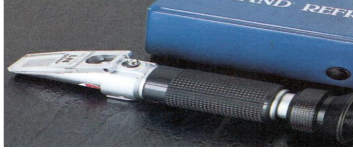
Şekil 1.5. Refraktometre (İşletmelerde pratik olarak haşıl çözeltisinin içerisindeki katı madde miktarı kontrolü için kullanılır)
