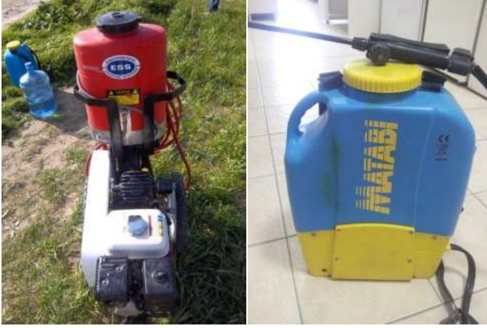
Şekil 3.3 Denemede kullanılan elektrostatik ilaçlama makinası ve sırt pülverizatörü
