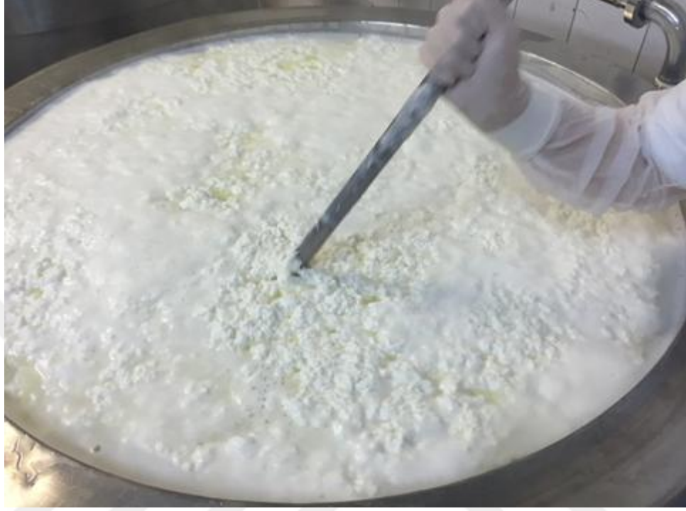
Ek 2. Sütün sıcaklık ve laktik asit etkisiyle pıhtılaştırılması
