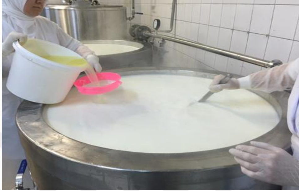
Ek 1. Yoğurt yada ekşi peyniraltı suyunun sıcak süte ilavesi
