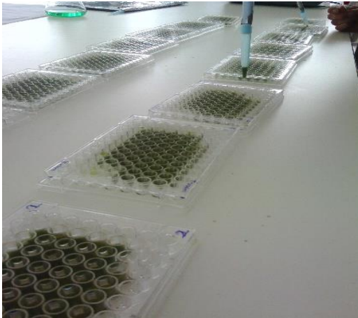
Şekil 3. 6. Örneklerin mikroyeytlere yüklenmesi
