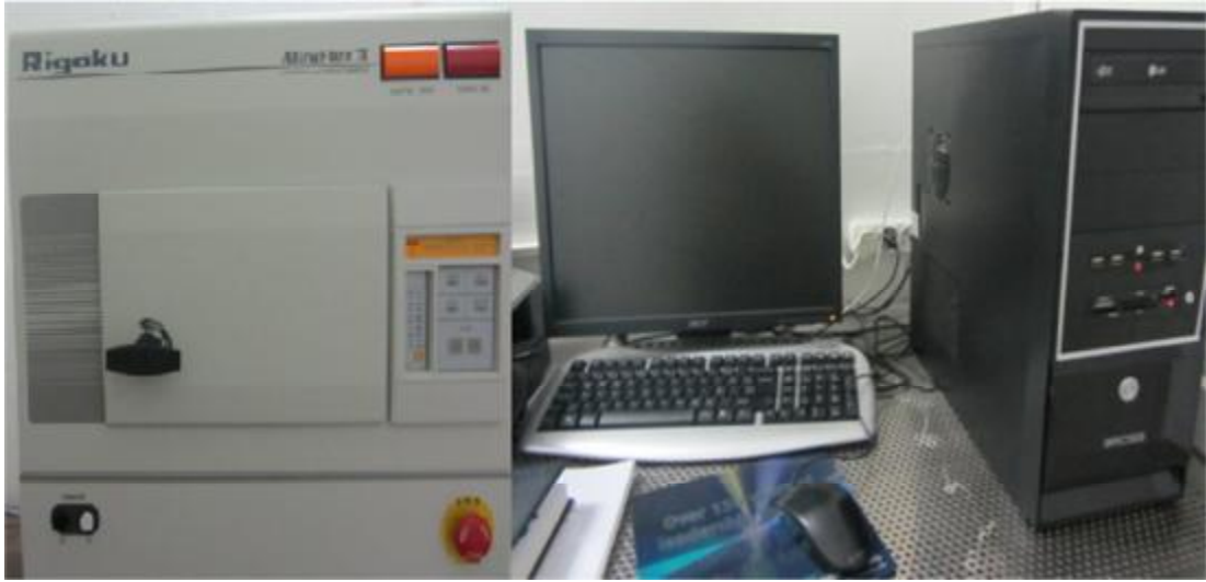
Şekil 3.15. Kristallik karakterizasyonlarının yapıldığı XRD cihazı.
