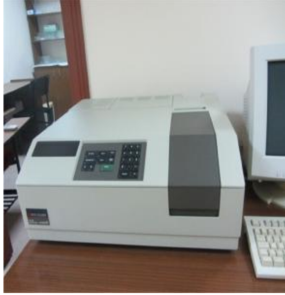
Şekil 3.16. Optik karakterizasyonların yapıldığı UV-VIS-NIR spektrofotometre cihazı.
