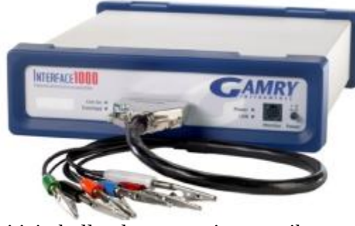
Şekil 3.7. CV ölçümleri için kullanılan potansiyostat cihazı.
