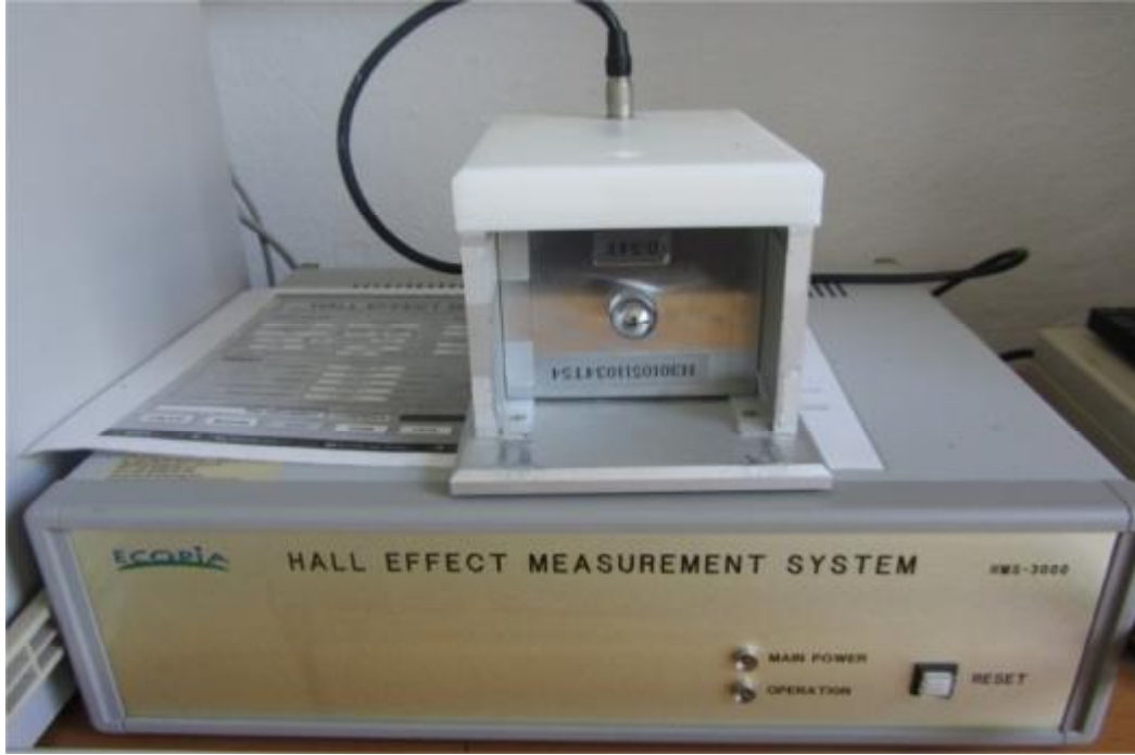
Şekil 3.17. Elektriksel karakterizasyonların yapıldığı Hall ölçüm cihazı.
