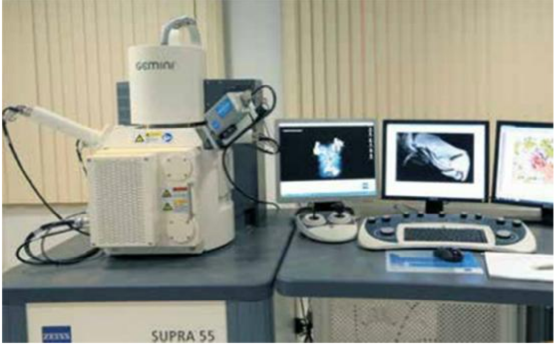
Şekil 3.18. Yüzey ve kesit karakterizasyonlarının yapıldığı FESEM cihazı.
