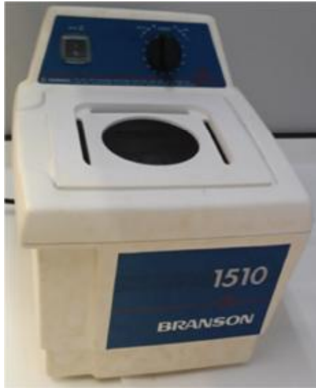
Şekil 3.9. Alttaban temizliğinde kullanılan ultrasonik titreştirici.
