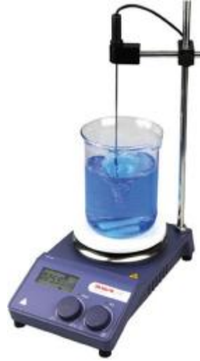
Şekil 3.11. Laboratuvarımızda bulunan ısıtıcılı manyetik karıştırıcı cihazı.
