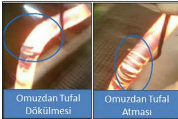
Şekil 6.10 : Boru denge çubuğu tufal atma detayları
