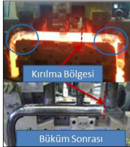
Şekil 6.9 : Boru denge çubuğu imalatında tufal oluşumu
