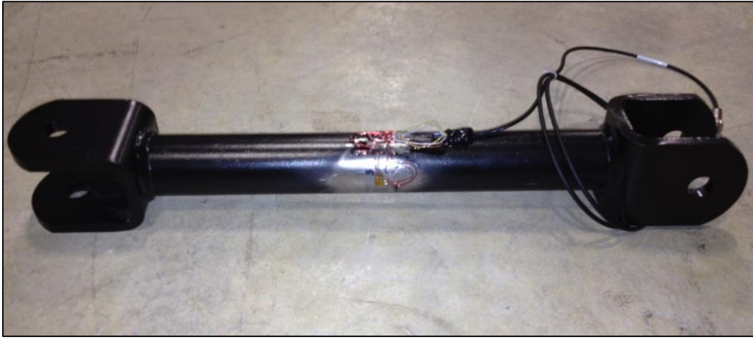
Şekil 6.26 : ARB linki – tam köprü strain gage bağlantısı.
