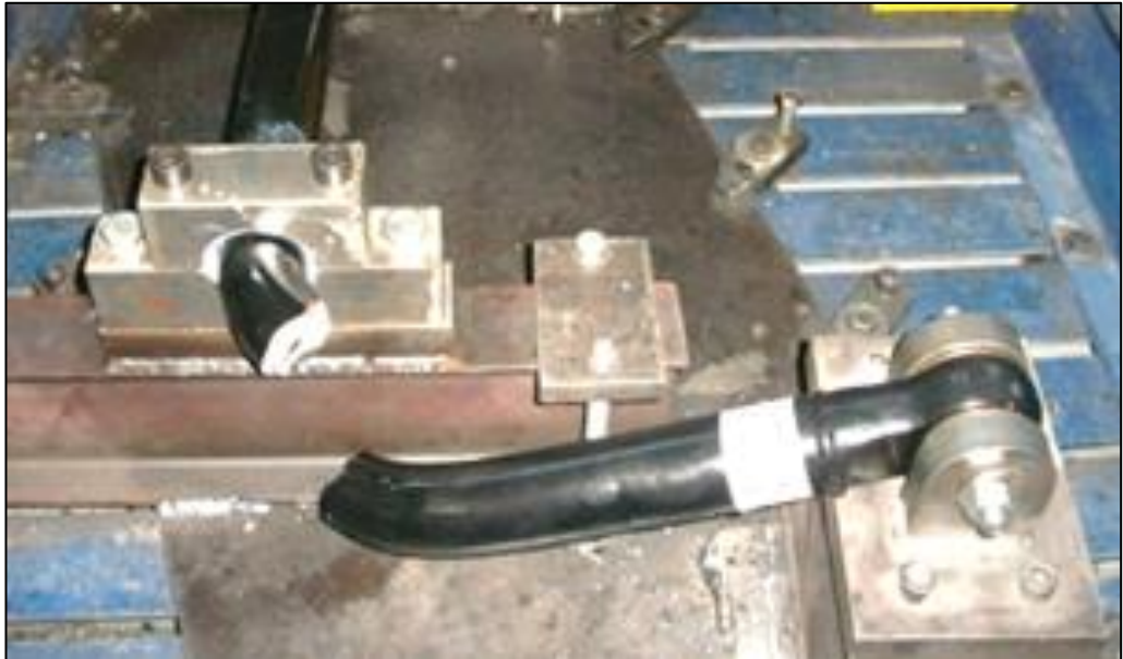
Şekil 6.13 : Kabuk soydurulmuş boru denge çubuğu kırılma örneği
