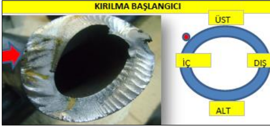
Şekil 6.14 : Kabuk soydurulmuş boru denge çubuğu kırılma başlangıcı lokasyonu
