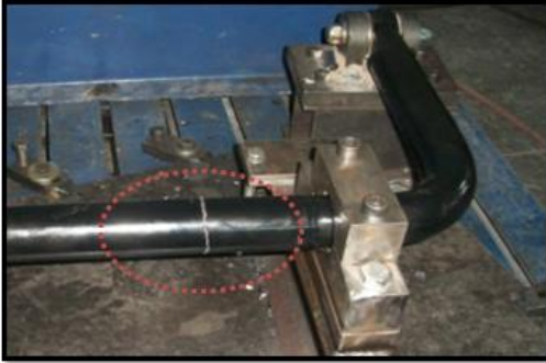
Şekil 6.4 : Dolu denge çubuğu kırılma örneği
