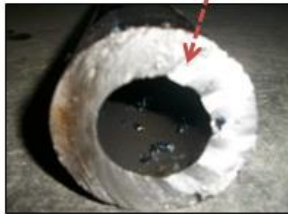
Şekil 6.5 : Boru denge çubuğu kırılma örneği
