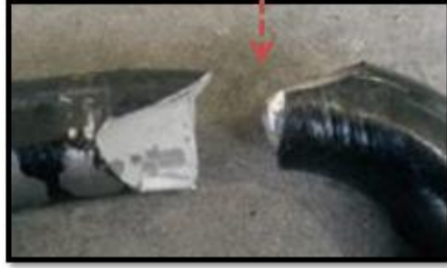
Şekil 6.4 : Dolu denge çubuğu kırılma örneği
