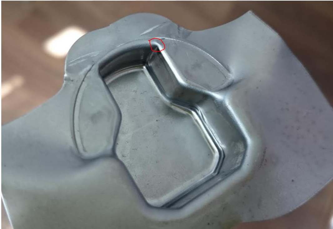
Şekil 5.30 : Yerel kalınlaşmanın gerçek deney numunesi üzerinde gösterimi
