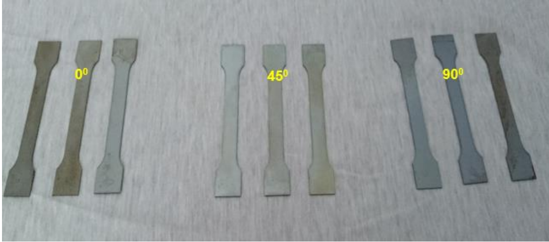
Şekil 4.14 : Haddelene yönüne 0^\circ , 45^\circ ve 90^\circ hazırlanmış çekme deneyi örnekleri
