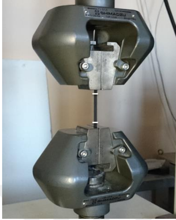
Şekil 4.16 : Deney örneğinin çeneye bağlanmış görünümü
