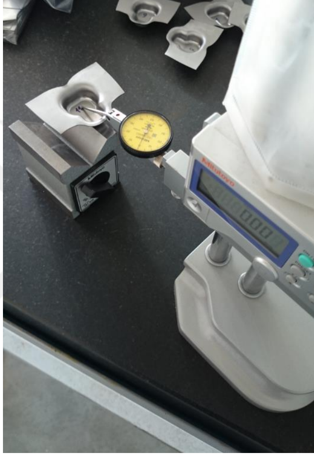
Şekil 4.6 : Çanak derinliğinin mihengir ile ölçüm işlemi
