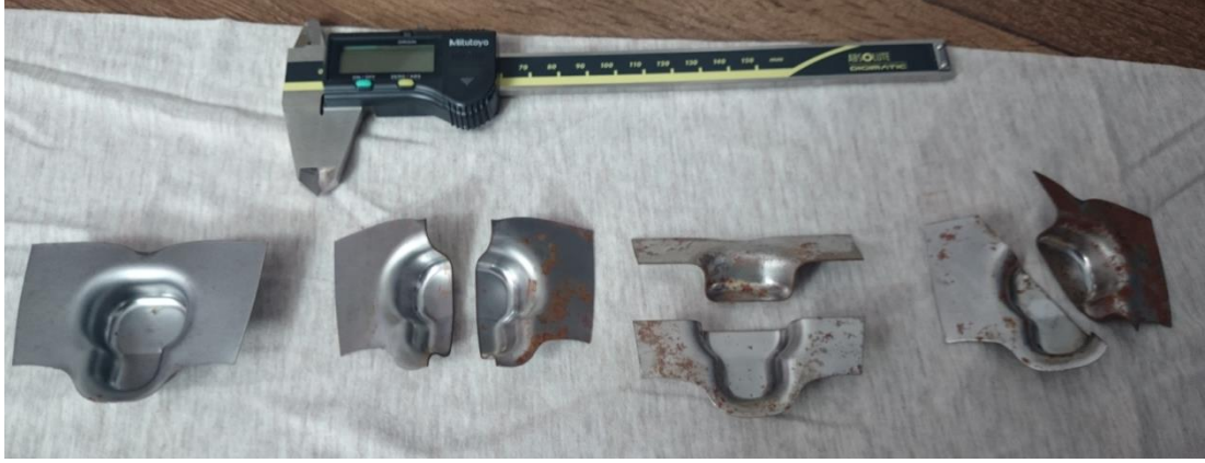
Şekil 4.7 : Kalınlık ölçümü için parçanın kesilmiş görüntüleri
