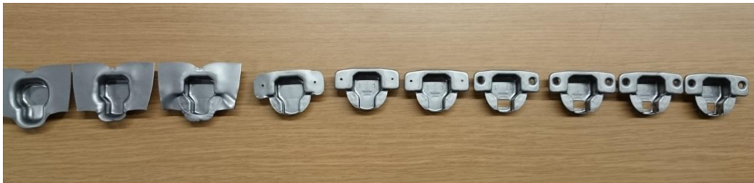
Şekil 1.1 : 11 baskıda sac metalin oluşan formu
