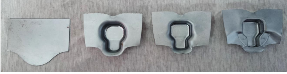
Şekil 4.2 : Kesme ve derin çekme aşamalarına ait görünümeler
