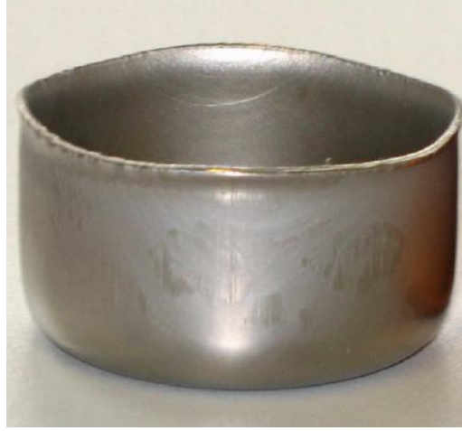
Şekil 3.14 : Kulaklanmaya ait örnek, ferritik paslanmaz çelik X6Cr17 [62].
