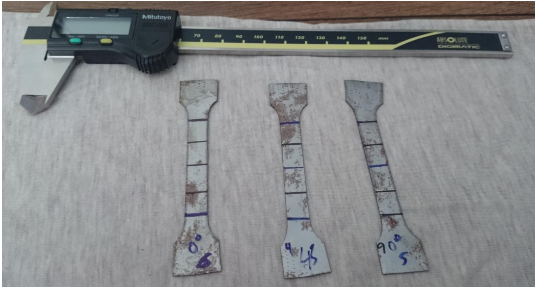
Şekil 4.18 : Anizotropi deneylerinde kullanılan çekme örnekleri
