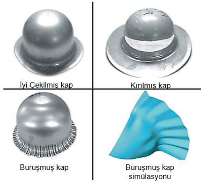
Şekil 3.27 : Pot çemberi kuvvetinin etkisi [33].
