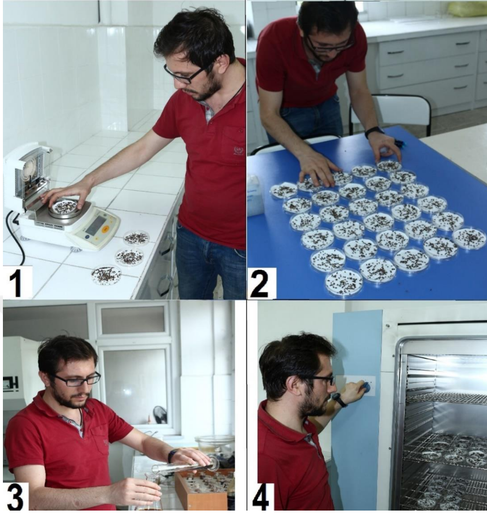
Şekil 4: Laboratuvarda çimlendirme testlerinin aşamaları. 1: Araştırmada kullanılan tohumların petri kaplara homojen dağıtılması için tartılması, 2: Tohumların petri kaplara konulması, 3: Beher kaplarda çözeltilerin hazırlanması ve petri kaplardaki tohumlara uygulanması, 4: Tohumların çimlendirme testi için iklimlendirme dolabına yerleştirilmesi.
