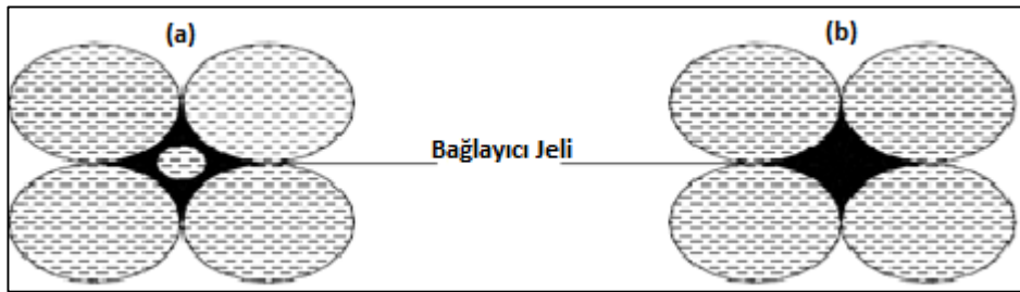
Şekil 2. 16: İyi bir tane boyu dağılımına sahip olan (a) ve olmayan (b) malzemeden üretilen macundaki bağlayıcı jel görünümü (Yılmaz ve diğ., 2003).
