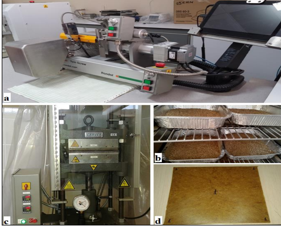
Şekil 4.1. Üretim işlemlerinde kullanılan ekstrüder (a), ekstrüzyon işlemi sonrası elde edilen pelet halindeki kompozitler (b), pres (c), pres işleri sonrası elde edilen levha (d)
