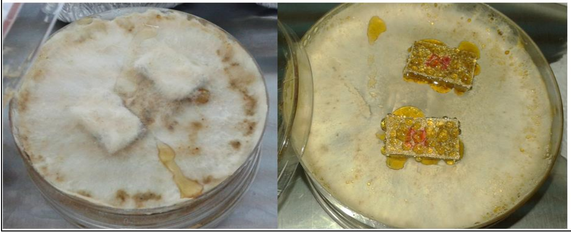
Şekil 5.3. Coniophora puteana mantarı ile inkübe edilmiş kompozit örnekleri (sağdaki örnek (11. Grup) %2 çinkoborat içermektedir, soldaki örnek (10. Grup) çinko borat içermemektedir.)
