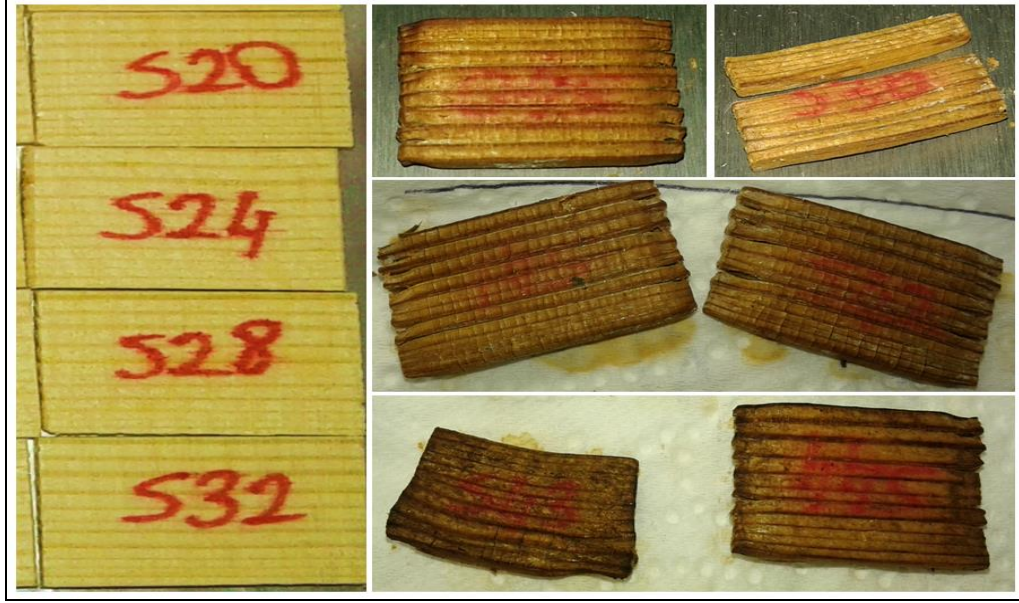
Şekil 5.5. Mantar ( Postia placenta ) çürüklüğüne maruz kalan odun örneklerinin görünümü
