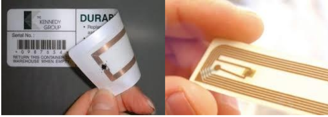
Şekil 2.14. Tipik Bir RFID Etiketinin Görünüşü (Okyanus Teknoloji, 2006)
