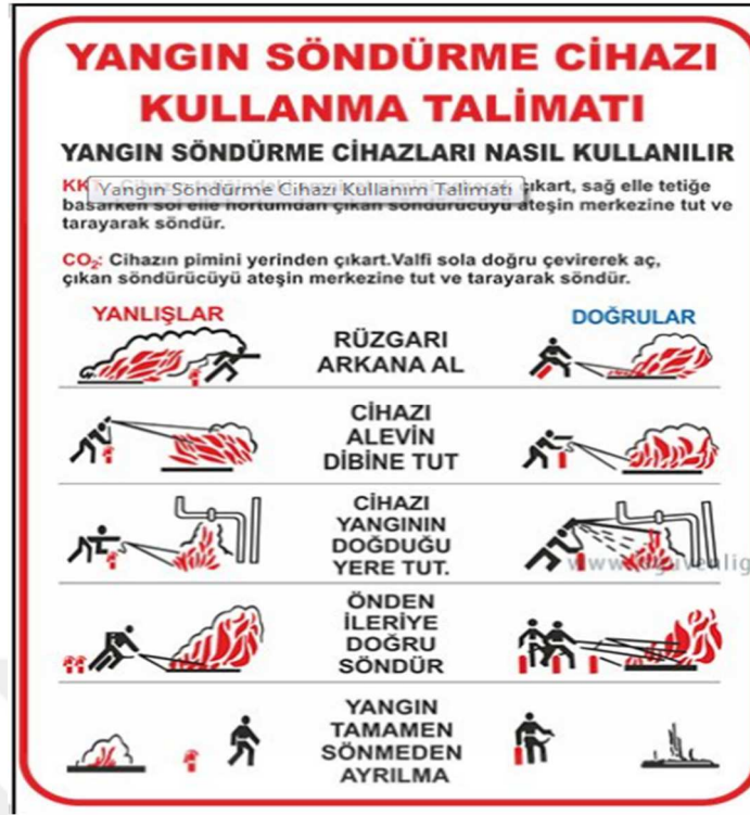
Şekil 15. Yangın söndürme cihazı kullanma talimatı
