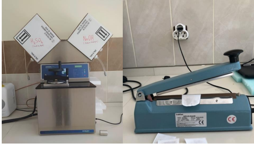
Şekil 3.10. a) Tam otomatik selüloz tayin cihazı, b) Filtre keselerinin yapıştırılması
