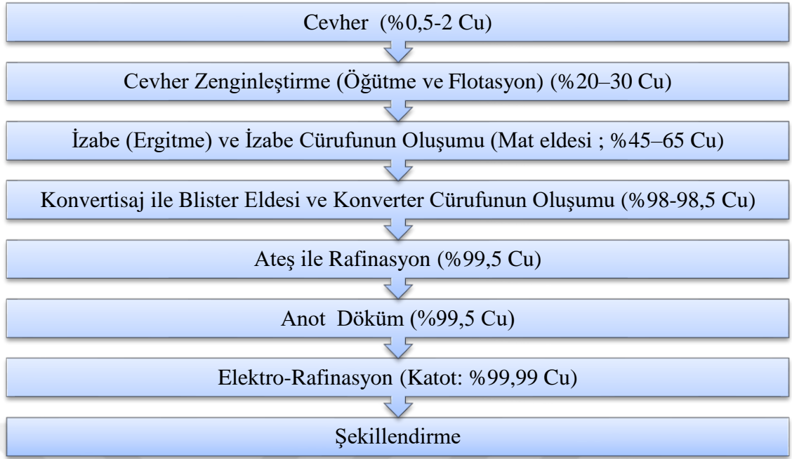
Şekil 2. 2 : Pirometalurjik yöntem ile bakır üretim akışı, (Schlesinger ve diğerleri, 2011)'den uyarlanmıştır.
