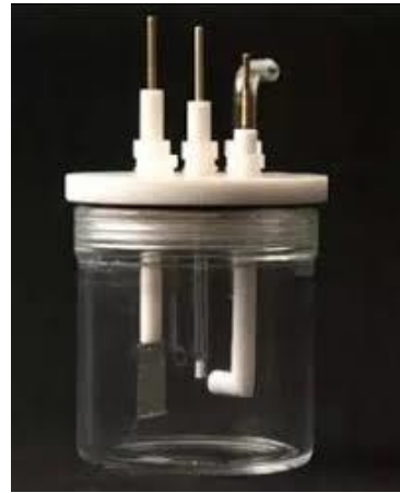
Şekil 1.3. Voltametrik Hücre içerisindeki 3'lü elektrot sistemi
